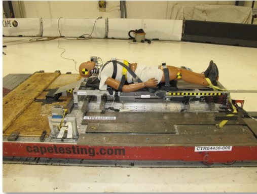
[J3027 구급차 이동시트 안전성 테스트 장면] [각기 다른 이동시트 간의 비교를 통한 안전도 측정방법]
