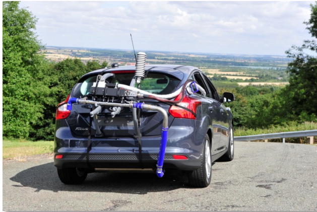
[일상주행 배기가스 검증 장치 부착 모습]
